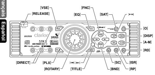
With the Dual Action opened / Lorsque la Double action est ouverte Con el panel frontal de acción doble abierto
